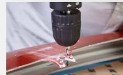
**2 шаг.** Удалим лакокрасочное покрытие с пластикового элемента, снимем фаску с помощью напильника и просверлим 2 отверстия на границе отломленной части. Отверстия создадут прочный «замок».
