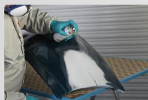
**3 шаг.** Поверхность обрабатывается Активатором адгезии 3M™ 05917. Время выдержки должно составлять 10 минут.
