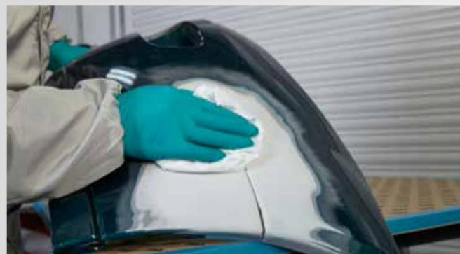
**1 шаг.** Любой ремонт начинается с обработки поверхности очистителем. Для этого идеально подойдет Универсальный очиститель клеев 3M™ 08984.
