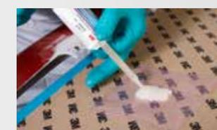
**5 шаг.** Нанесем на пленку состав для быстрого восстановления пластиковых деталей 3M™ Automix™, короткий номер 55045. Состав наносится при помощи ручного пистолета 3M™ ерх.
